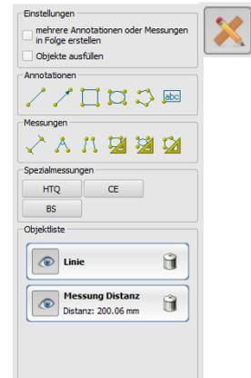
Der Schalter „mehrere Annotationen oder Messungen in Folge erstellen“ bewirkt, dass das ausgewählte Zeichenobjekt aktiviert bleibt. So können zum Beispiel mehrere Distanzmessungen hintereinander gezeichnet werden, ohne dass diese erneut für jede Messung angeklickt werden muss. Wenn Sie alle Messungen gezeichnet haben, beenden Sie diesen Modus mit einem Doppelklick auf die Bildfläche oder der Taste ESC.
