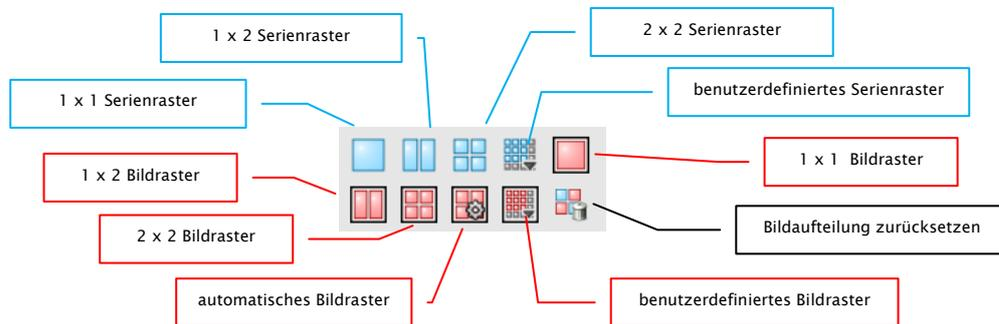
Das Bildfenster kann in verschiedene Teilfenster aufgeteilt werden, sodass die einzelnen Serien einer Untersuchung in einem Raster angeordnet werden können. Die Teilfenster der Serien lassen sich weiter unterteilen, sodass die Einzelbilder in einem Raster dargestellt werden.
