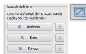
Das Setzen eines Auswahlbereichs eines bestimmten Typs ersetzt einen eventuell schon existierenden Auswahlbereich dieses Typs.
