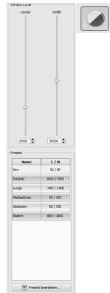
Mit der automatischen Fensterung lassen sich zusätzliche spezielle Voreinstellungen festlegen, die dann mit einem Klick für das geöffnete Bild angewendet werden.
