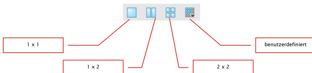
Die große Bildanzeige kann ein oder mehrere Bilder darstellen. Wie viele Bilder angezeigt werden sollen, kann über diese Schalter in der Symbolleiste oberhalb der Bildanzeige ausgewählt werden (1x1, 1x2, 2x2). Zusätzlich kann über einen letzten Schalter, der ein kleines Fenster öffnet, auch eine benutzerdefinierte Einstellung bis maximal 6x6 gewählt werden. Um ein Bild in einem der Fenster zu bearbeiten, aktivieren Sie es im Viewer. Das aktive Fenster wird dann mit einem roten Rahmen markiert.
