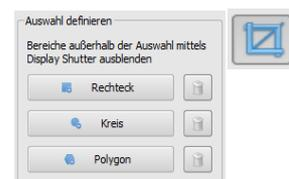
Das Setzen eines Auswahlbereichs eines bestimmten Typs ersetzt einen eventuell schon existierenden Auswahlbereich dieses Typs.
