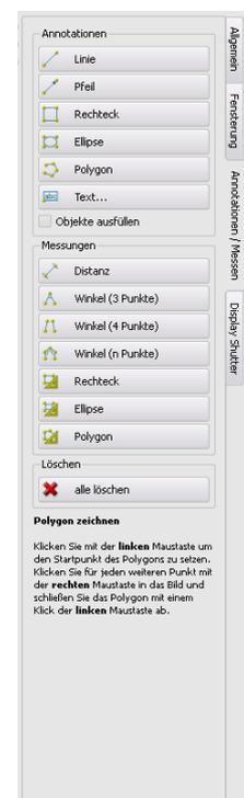
Durch Klicken Schalter „Rechteck“, „Ellipse“ oder „Polygon“ im unteren Messungsbereich bei gedrückter Shift-Taste, können Dichten gemessen werden. Dabei wird neben der Figur der tatsächliche mittlere Grauwert aus den Originalpixelwerten, sowie minimaler und maximaler Grauwert angetragen. Für Farbbilder wird eine normale Flächenmessung durchgeführt.
