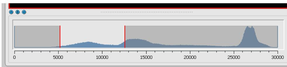
Für Farbbilder wird eine rote, grüne und blaue Kurve für den R-, G- und B-Kanal des Bildes angezeigt. Für Graustufenbilder eine blaue Kurve (wie im obigen Bild dargestellt) für die Verteilung der Grauwerte.
