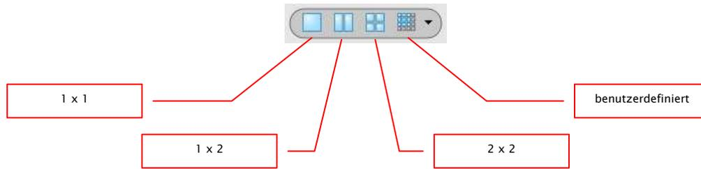
Die große Bildanzeige kann ein oder mehrere Bilder darstellen. Wieviele Bilder angezeigt werden sollen kann über diese Schalter in der Symbolleiste oberhalb der Bildanzeige ausgewählt werden (1x1, 1x2, 2x2). Zusätzlich kann über einen letzten Schalter, der ein kleines Fenster öffnet, auch eine benutzerdefinierte Einstellung bis maximal 6x6 gewählt werden.
