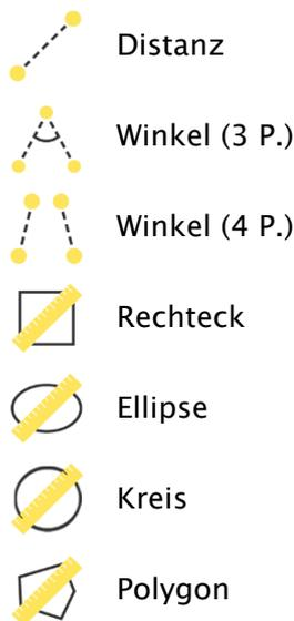
Bei Rechteck, Ellipse, Kreis und Polygon werden der Flächeninhalt und auch die Dichten gemessen. Dabei wird neben der Figur der tatsächliche mittlere Grauwert aus den Originalpixelwerten sowie minimaler und maximaler Grauwert angezeigt. Für Farbbilder wird nur die normale Flächenmessung durchgeführt. Bei CT-Serien werden bei diesen Objekten die Werte in Hounsfield units (HU) angezeigt.
